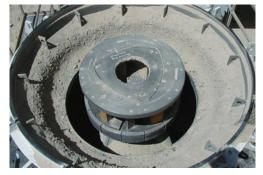
La chambre de broyage autogène équipée de la technologie de broyage « pierre contre pierre » accepte tous les types de pierres, y compris les matériaux très abrasifs. Ce type de configuration permet d'obtenir des matériaux de taille et de forme régulières.
